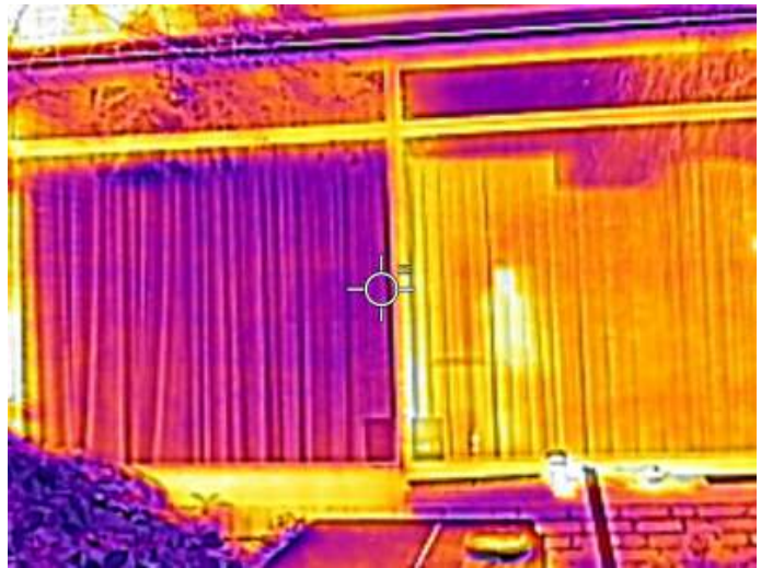
Links HR++ glas, rechts dubbel glas met de reflectie van de fotograaf
